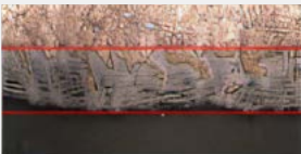
Corrosion Layer ~ 300µm
